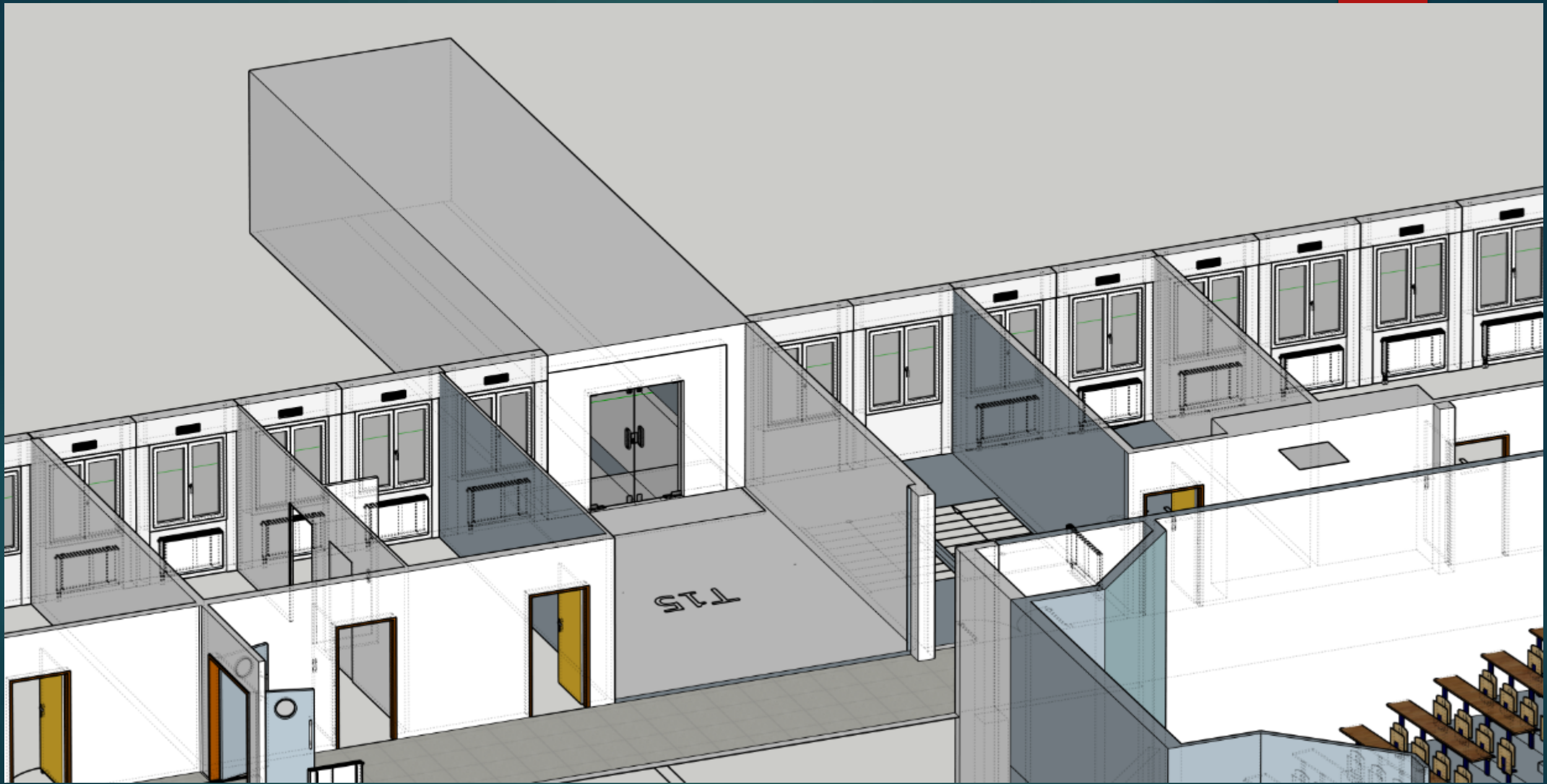
Arrivée de la passerelle côté bâtiment technique (utilisation de la salle T15 comme espace de liaison)
